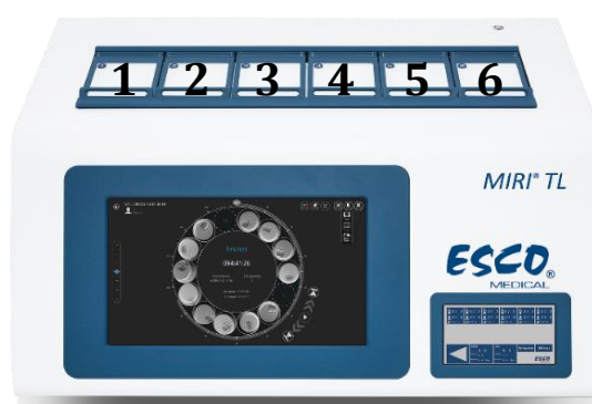
7.1 ábra Kamraszámok a MIRI® TL6 többkamrás IVF-inkubátoron
