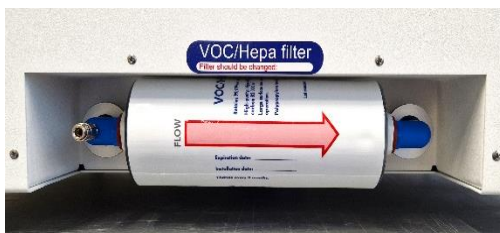
12.3 ábra Megfelelően behelyezett VOC/HEPA-szűrő
