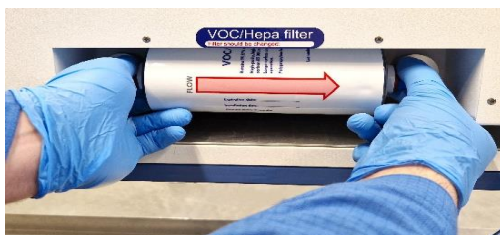
12.2 ábra A VOC/HEPA-szűrő behelyezése és eltávolítása
