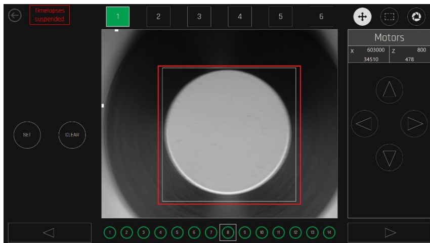
20.39 ábra Megfelelően beállított csésze nézete
